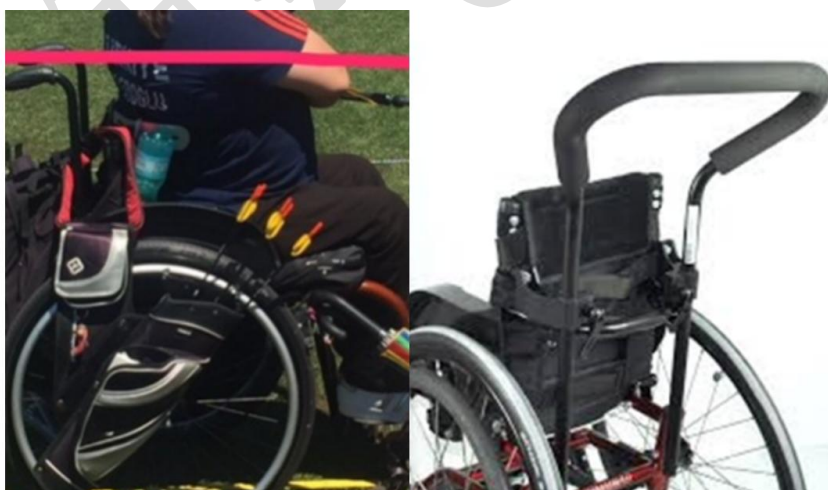
図 31 : 車椅子の背面部分に直接取り付けられていない手押しハンドル
